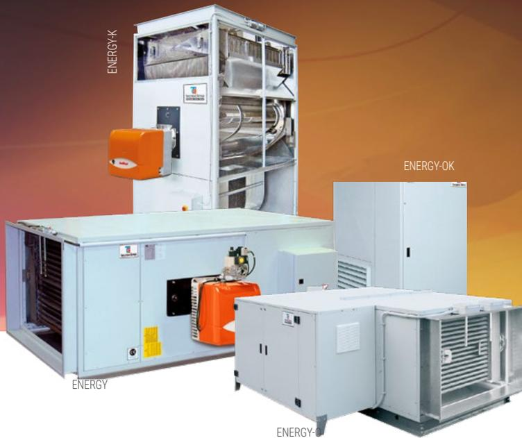
Generadores de aire caliente a condensación Heatsun con quemador Baltur de gas o gasóleo, Potencias de 60 a 970 Kw con ventiladores centrífugos para canalización del aire o de descarga directa con plenum opcional, presión disponible estándar de 220 Pa con opción de 450 Pa, versiones en vertical y horizontal para interior y exterior.
